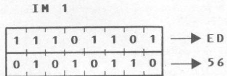
Esta instrução seta o modo de interrupção para o modo 1. Neste modo, o microprocessador responde a uma interrupção com um restart para a posição de memória 38H.
